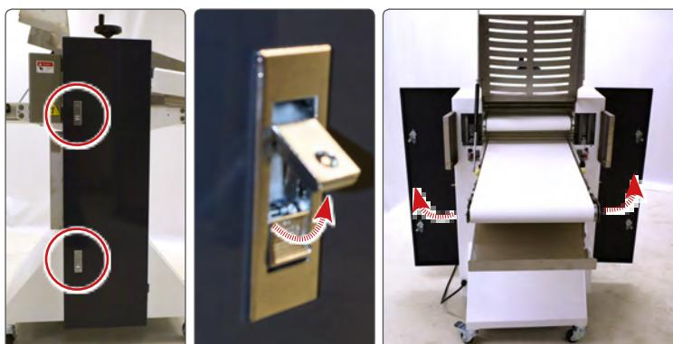
Déverrouillez les verrous poussoirs des deux côtés de la machine et ouvrez les portes.
