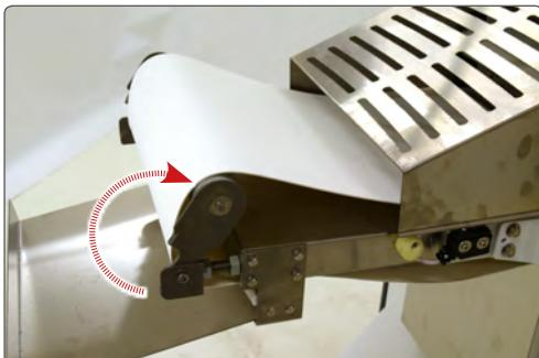
Klap de tafel open om de transportbanden gemakkelijk te reinigen
