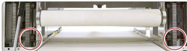
Controleer of het mes aan beide kanten op dezelfde hoogte zijn geplaatst.
