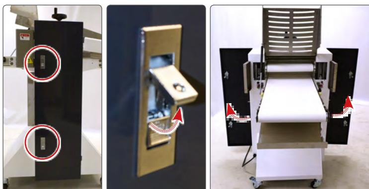
Druk op de duwsloten op de deuren aan de zijkanten van de machine en open de deuren.
