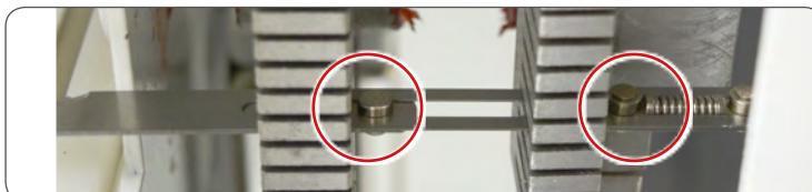
Controllare il corretto posizionamento delle guide di scorrimento durante il montaggio della lama.
