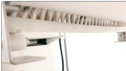
Mentre il nastro trasportatore è in funzione, la spazzola viene passata sulla parte inferiore del ripiano.
