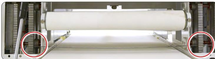
Sicherstellen, dass die Klinge auf beiden Seiten auf der gleichen Höhe eingebaut ist.
