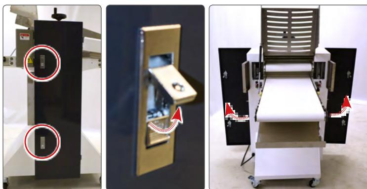
Die Drucktastenschlösser an den Türen auf beiden Seiten der Maschine entriegeln und die Türen öffnen.
