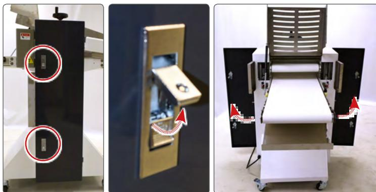
Presione los bloques de las puertas a ambos lados de la máquina y abra las puertas.
