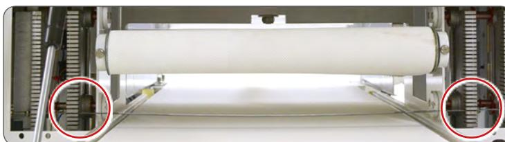
Compruebe que la cuchilla esté montada a la misma altura en ambos lados.
