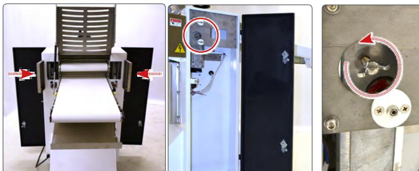
Die Flügelmuttern auf beiden Seiten der Maschine lösen.
