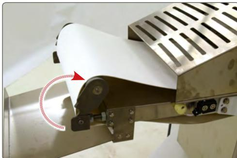
Pivotez la table pour un nettoyage facile de la bande transporteuse. Gardez la bande transporteuse et la table propres. Utilisez un chiffon humide et une brosse. Éteignez la machine après une utilisation quotidienne. Utilisez un chiffon doux pour nettoyer le boîtier de la machine. Utilisez une brosse pour nettoyer les parties intérieures. Beaucoup de miettes restent sur la table, gardez la table autant que possible sans miettes.
