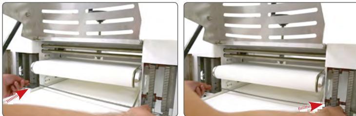
Primero, deslice el cuchillo en un lado del soporte de la cuchilla dentro de la ranura de la cuchilla a la altura deseada.
