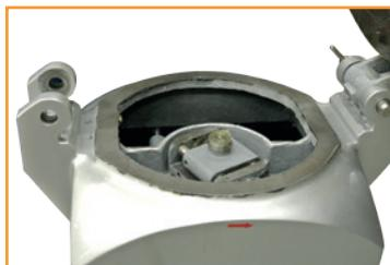
De opbolplaat moet op een correcte manier terug geplaatst worden. De inkepingen in de plaat moeten op de bovenste geleidingsvlakken van de zijkant van de machine passen en de pin van de aandrijfas moet in de ronde uitsparing van de opbolplaat passen.
