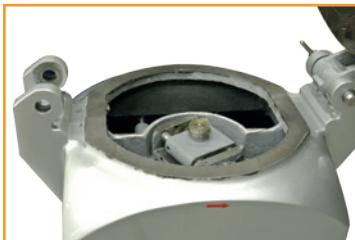
Rimettere la piastra e posizionarla correttamente al suo posto. Le fessure nella parte inferiore della piastra devono combaciare con i piani conduttrici superiori del lato verticale. Il nottolino dell' albero motore deve anche combaciare con la sede del cuscinetto a sfera della piastra posizionata.
