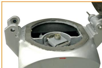
Mettez la plaque à bouler de nouveau correctement à sa place. Les crans du côté inférieur de la plaque à bouler doivent s'emboîter avec les surfaces supérieures du corps de la machine. Le cliquet de l'arbre d'entraînement doit aussi s'emboîter avec la plaque à bouler.
