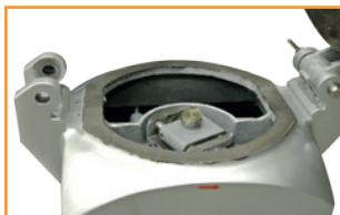
Entfernen Sie jetzt bitte die Wirkplatte Nr. 42 und füllen Sie das Öl, welches sich in einem Behälter im unteren Teil der Maschine befindet, in den dafür vorgesehenen Raum unterhalb der Wirkplatte.
