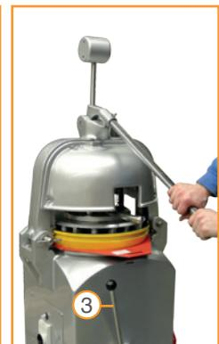
**B.** Plaats de opbolplaat met het deeg op de plaat van de machine. Bestrooi de opbolplaat niet met bloem. Eventueel bij kleverige degen mag de bovenkant van het deegstuk wel een beetje bestrooid worden.
